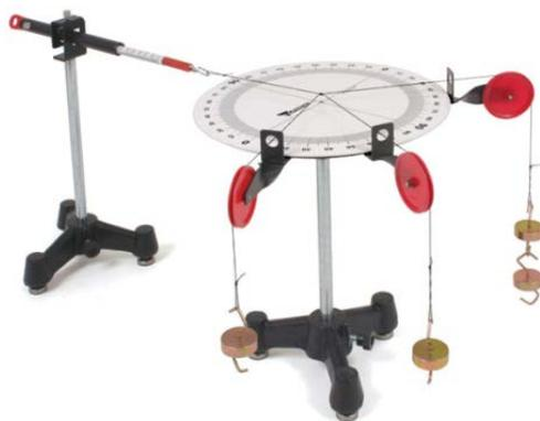
Figura 14: Mesa de força com dinamômetro.
