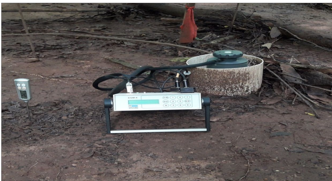
Figura 4. Analisador de gás por infravermelho portátil (EGM-4, PP Systems, U.K.) e a Câmara de efluxo de \text{CO}_2 do solo (SRC-1, PP Systems, U.K.) e - Termômetro digital tipo espeto, no fragmento de Cerrado em Tangará da Serra-MT.
