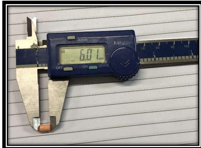
Figura 8 – Aferição do comprimento do corpo de prova com auxílio de paquímetro universal digital.
