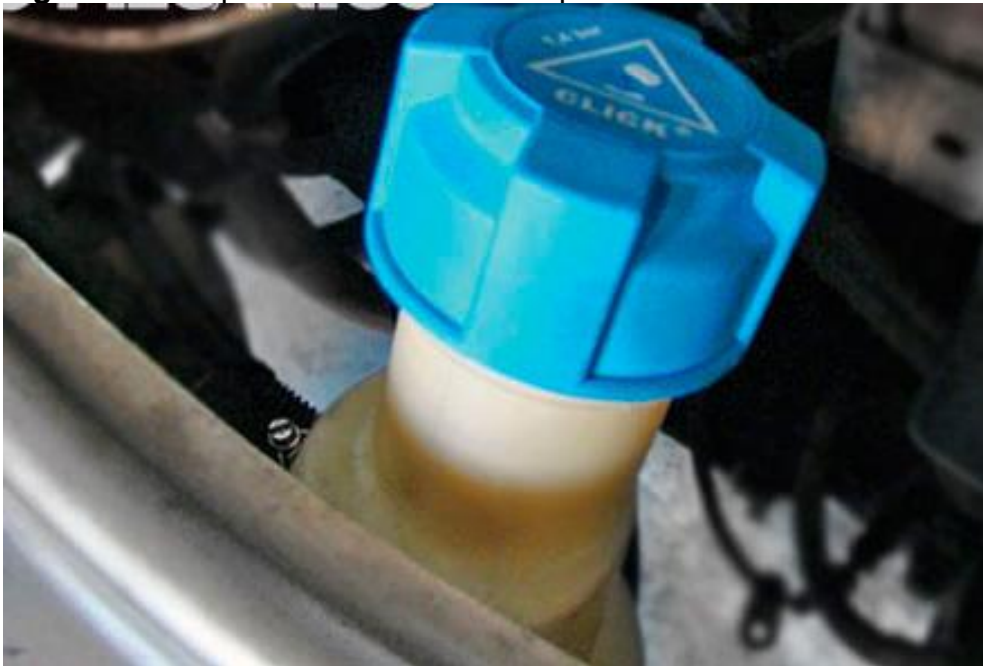
Figura 6 - Tampa do reservatório de líquido
