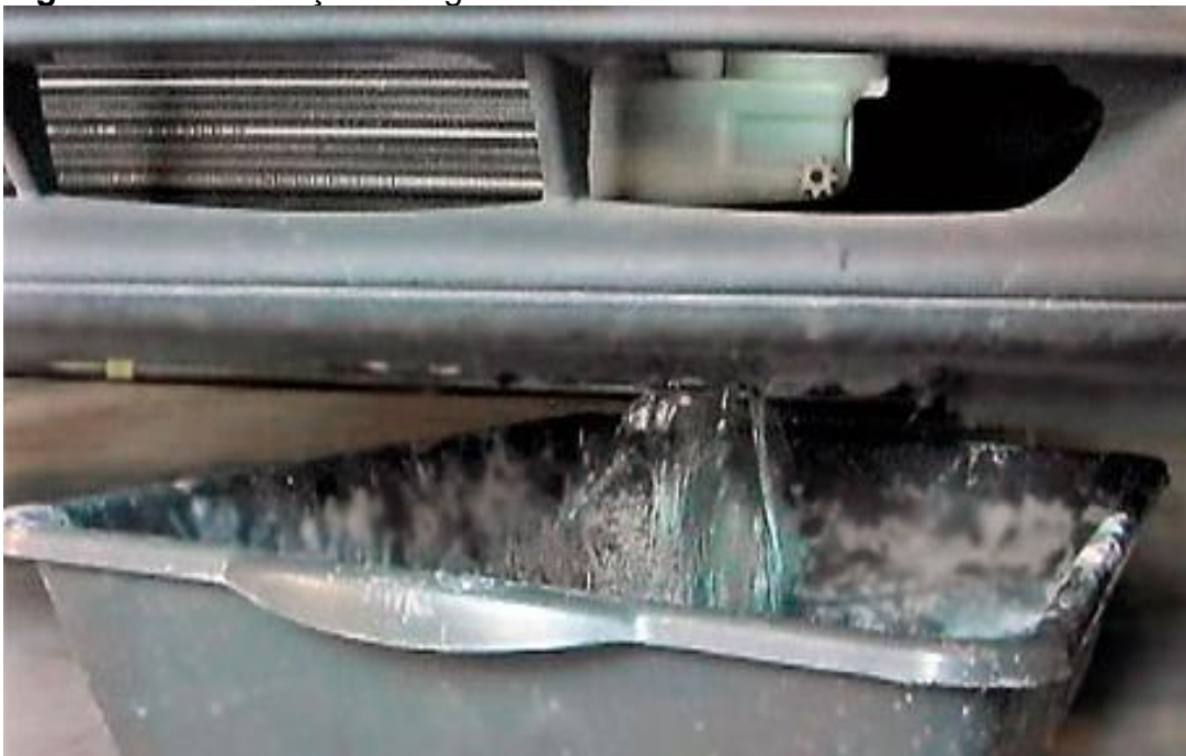
Figura 10 - Verificação de água com aditivo no sistema de arrefecimento
