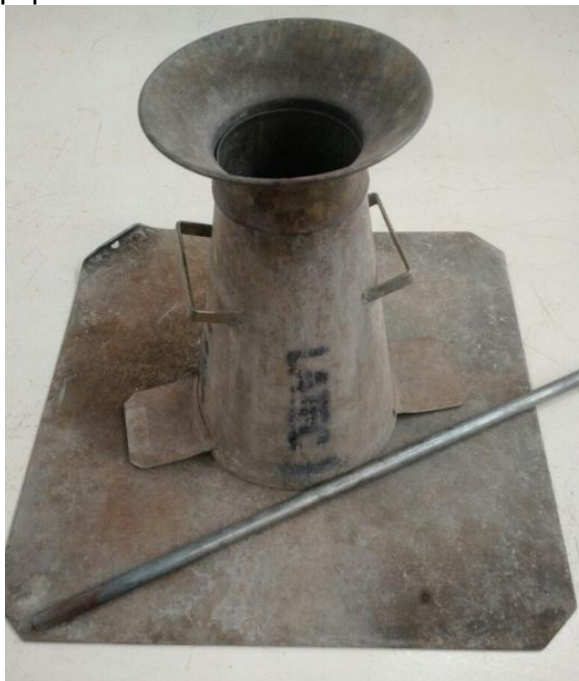
Figura 01 - Equipamentos do ensaio de abatimento.
