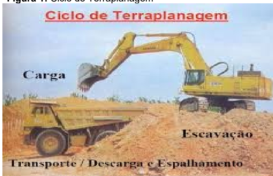
Figura 1: Ciclo de Terraplanagem
