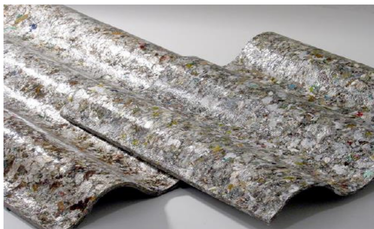
Figura 28: Telha fabricada em embalagem Tetra Pak
