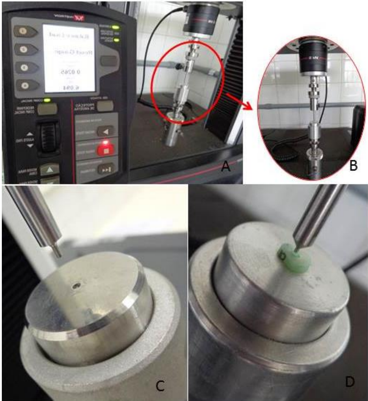
Figura 8 – A. Máquina de ensaio mecânico Instron 5965. B. Dispositivo para teste de resistência de união ( push-out ). C. Base metálica contendo orifício de 2 mm de diâmetro. D. Amostra posicionada no dispositivo.
