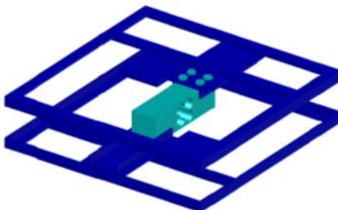
Figura 15 - Vista do lisímetro de pesagem somente com a célula de carga Fonte: O autor
