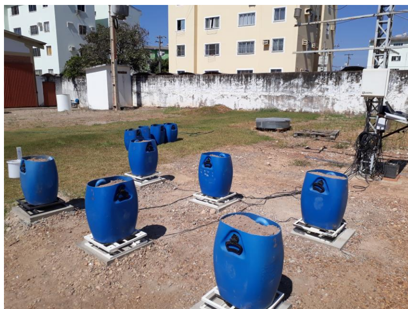
Figura 22 – Sistema de aquisição e armazenamento de dados – Células de Carga Fonte: O autor
