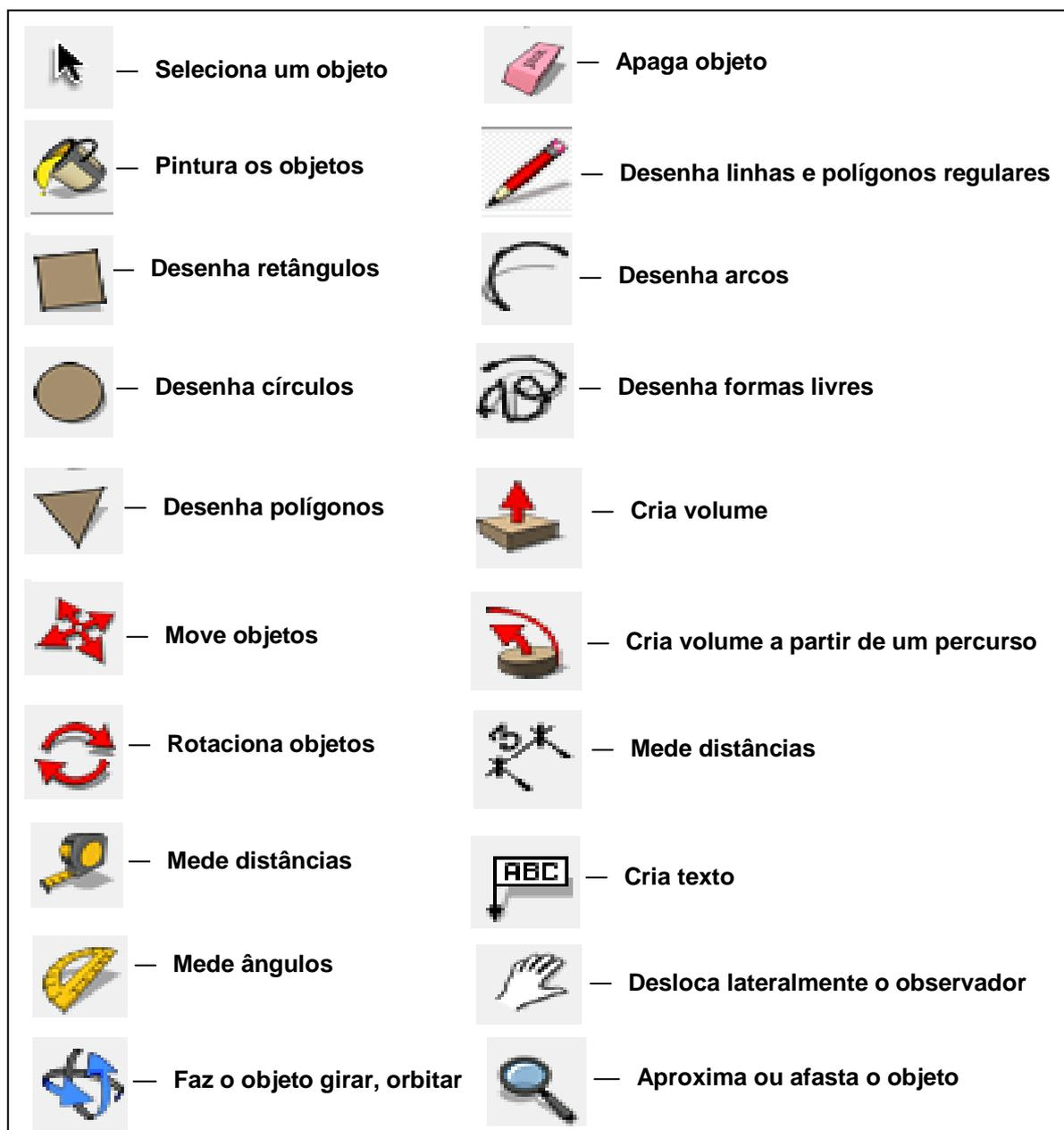
Figura 5: Ferramentas básicas do *software SketchUp*
