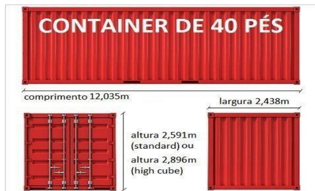
Figura 3 – Dimensões do container 40 pés.
