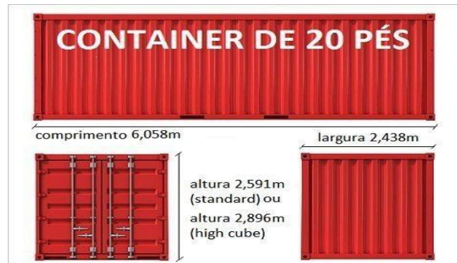
Figura 2 – Dimensões do container 20 pés.
