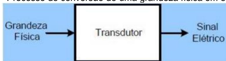
Figura 5 – Processo de conversão de uma grandeza física em sinal elétrico
