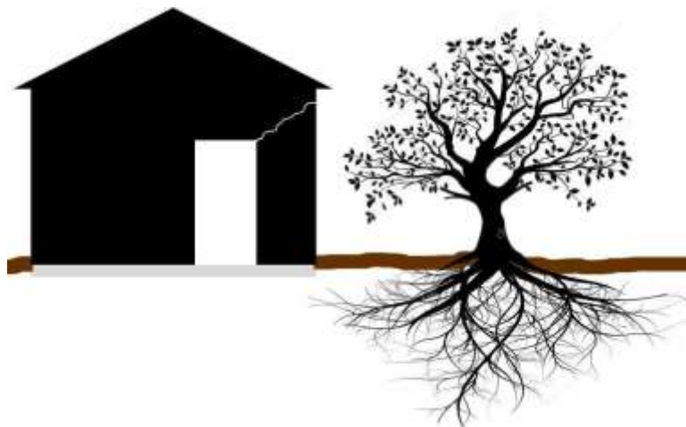
Figura 6 – Raízes ocasionando patologias.
