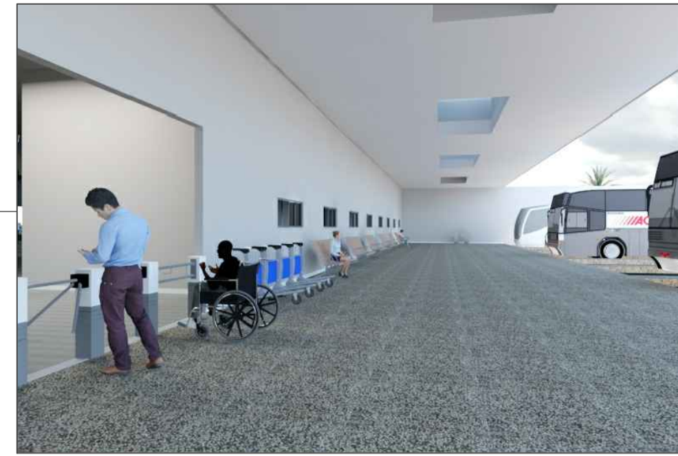
Perspectiva isométrica do setor de embarque e desembarque dos ônibus interestaduais. Conta com aberturas zenitais na laje, favorecendo a iluminação natural no ambiente. Sem escala
