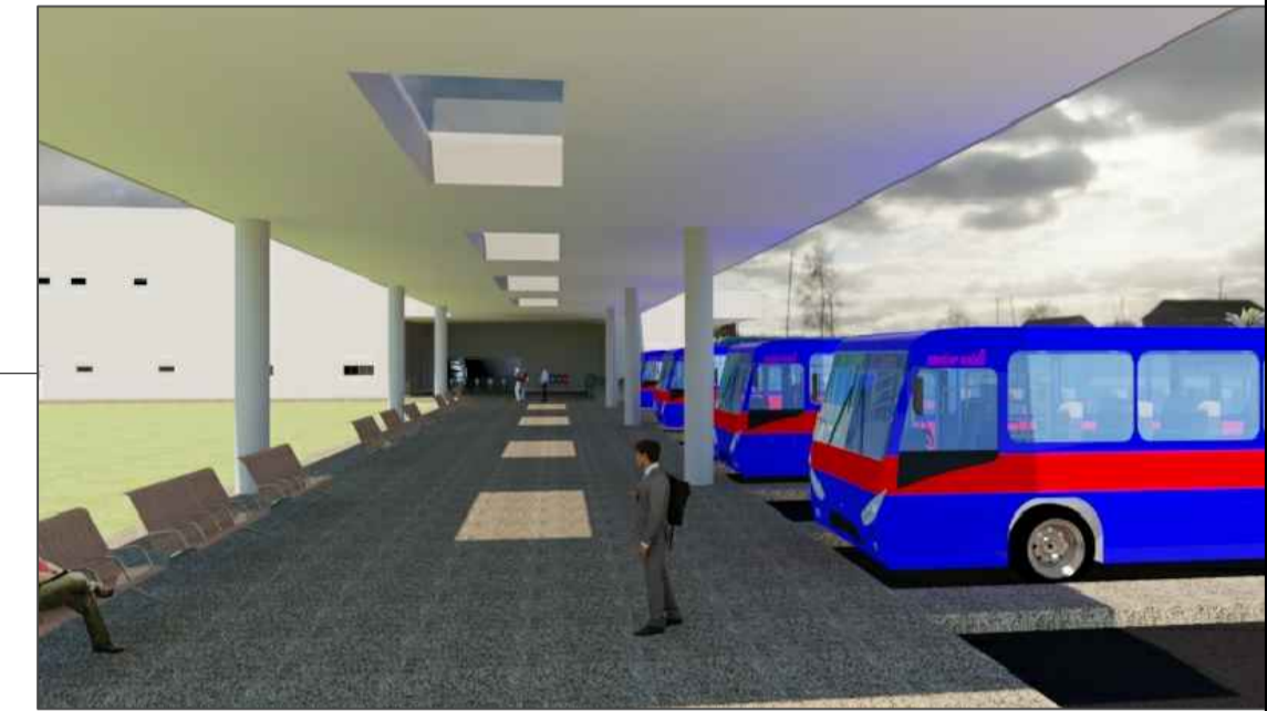
Perspectiva isométrica do embarque e desembarque dos ônibus municipais. Conta com aberturas zenitais na laje, favorecendo a iluminação natural no ambiente. Sem escala
