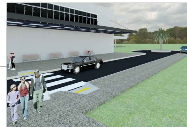
Perspectiva isométrica da vista do Cul-de-sac (A tradução mais adequada para o português é "balão de retorno", uma vez que é neste espaço terminam as ruas sem saída, constituindo solução adequada para automóveis retornarem ao sentido oposto à sua direção). Sem escala
