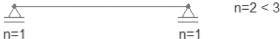
Figura 1.2 | Estrutura hipostática com graus de mobilidade permitidos pelos apoios inferiores às equações de equilíbrio
