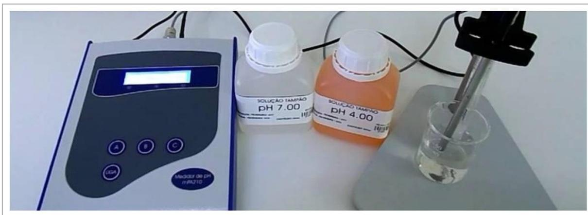
**FIGURA 6.** Verificação do pH da água deionizada e destilada.
