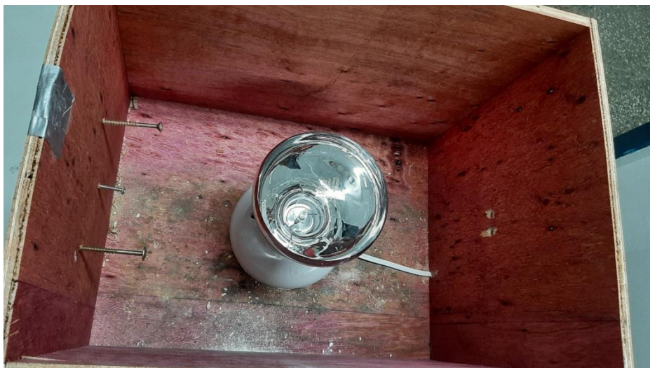
Figura 10. Mostra a posição da lâmpada de infravermelho no centro da caixa de madeirit.
