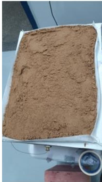
Figura 23. Areia em cima do porcelanato para realização da calibração.
