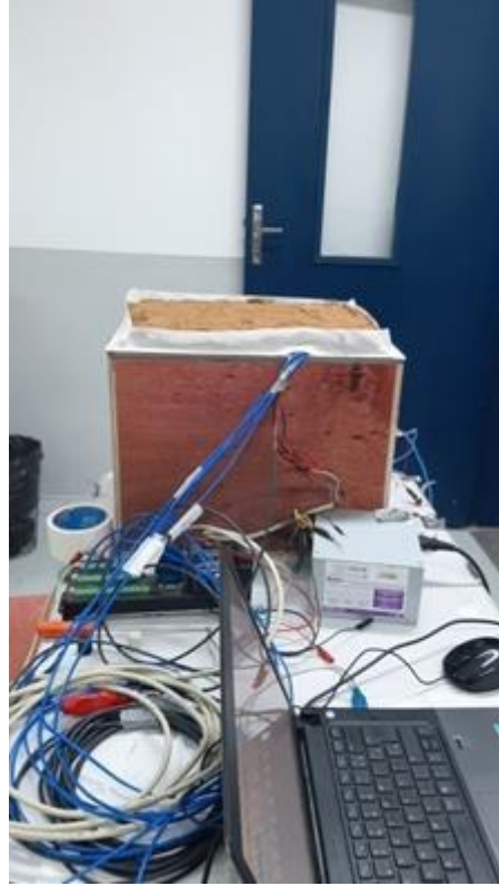
Figura 22. Equipamentos com a placa de porcelanato e areia para calibração.
