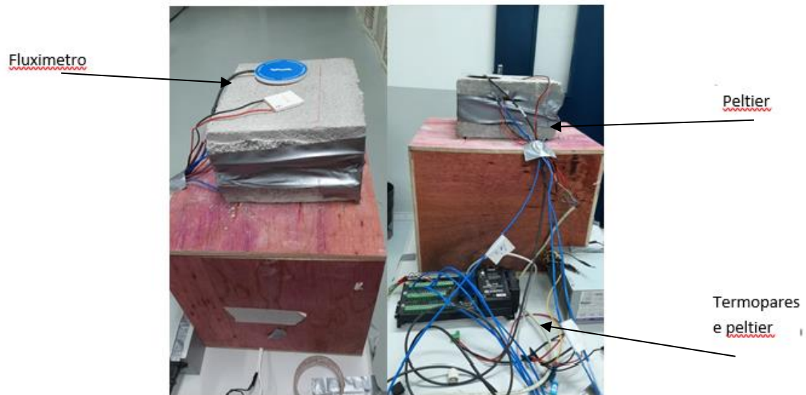
Figura 14 e 15. Mostra o tijolo concreto sendo preparado para a medição.
