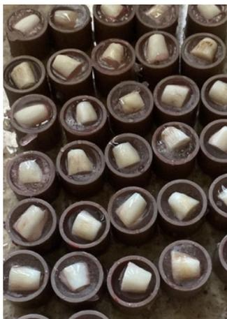
Figura 1 – Coroas posicionadas em anéis de tubo PVC.
